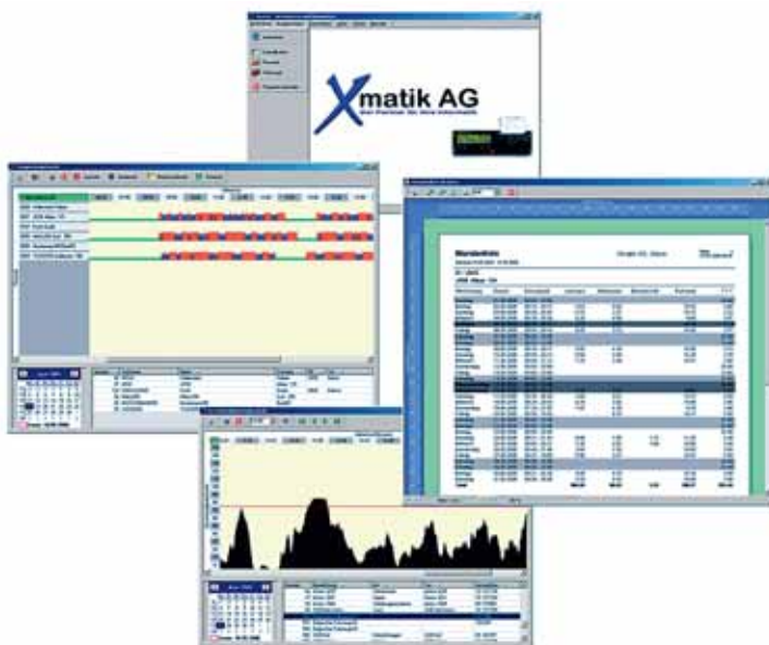
Übersicht: Das Softwarepaket Xtacho verbindet den digitalen Fahrtenschreiber mit dem Fuhrparkmanagement. Umfangreiche Auswertungen, wie beispielsweise die Arbeitszeiterfassung, steigern die betriebliche Effizienz.
